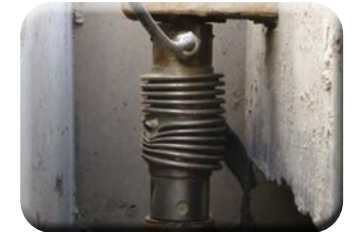
Fysisk skada Larm ges om lastcellens hölje skadas.
