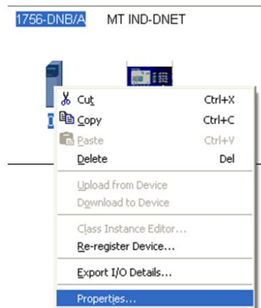
Figure 3-15 : Accès aux propriétés du scanner
